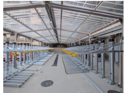
垂直2段式駐輪機の導入 (電動アシスト自転車等への対応)
