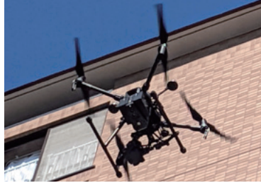
ドローンによる外壁調査
