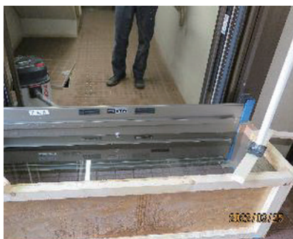
脱着式止水板「オクダケ」(止水能力実証テスト)
